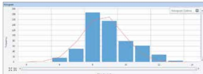
图 4. NIST 8011 10 nm Au 纳米颗粒的粒径分布，符合高斯分布。
